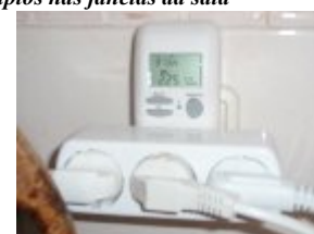
Temporizador e medidor de consumo de energia
